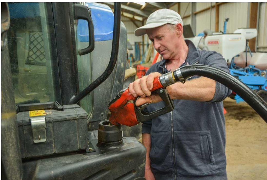
Avec une pompe stationnaire, le sol sur lequel le ravitaillement est effectué doit toujours être bétonné et étanche.
